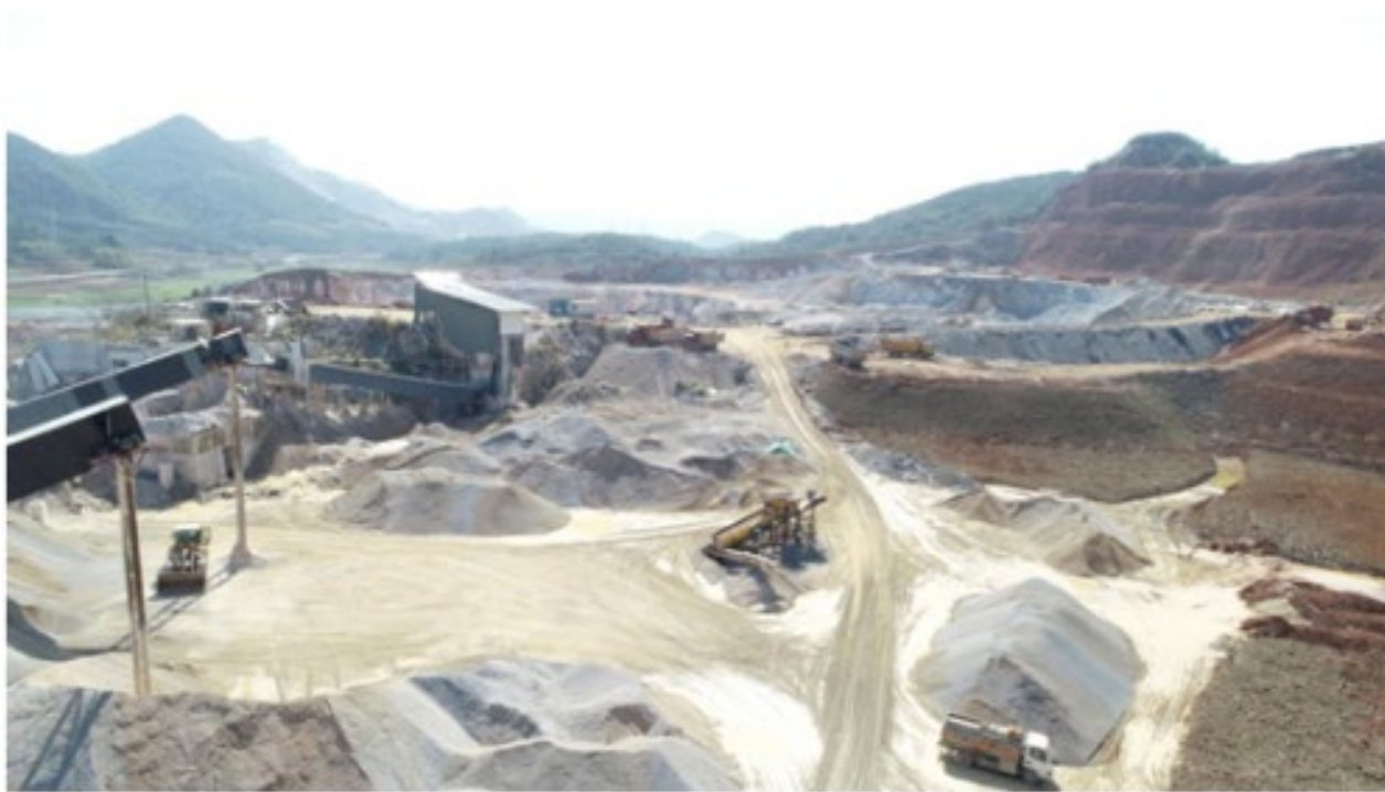
露天开采未采取喷淋降尘措施，带来粉尘污染
